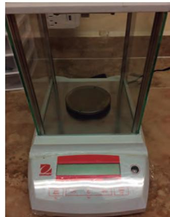
**Figura 1.** Balanza analítica Ohaus® (Pioneer™). La balanza es utilizada para la medición del peso del papel filtro, el Optosil® + Activador Universal Optosil®, de acuerdo al índice de Edlund y Lamm.<sup>5</sup>
